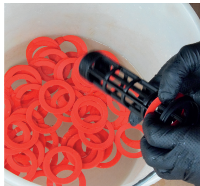
3) Togliere i dischi del filtro e lasciarli in ammollo per alcune ore con un acido, come aceto tal quale, per sciogliere il calcare depositato. Si sconsiglia l'impiego di acidi forti (ad esempio acido nitrico e acido cloridrico) perché fortemente caustici e pericolosi se non maneggiati con appositi dispositivi di protezione individuale. Procedere al risciacquo con acqua.
