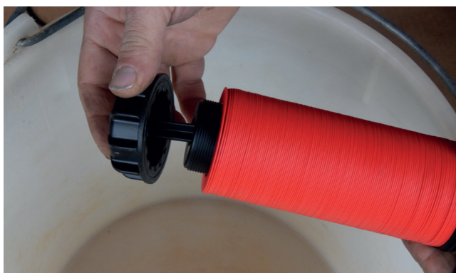
4) Rimontare il disco, evitando di tirare eccessivamente la vite, e inserire il filtro nella cartuccia
