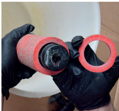
3) Togliere i dischi del filtro e lasciarli in ammollo per alcune ore con un acido, come aceto tal quale, per sciogliere il calcare depositato. Si sconsiglia l'impiego di acidi forti (ad esempio acido nitrico e acido cloridrico) perché fortemente caustici e pericolosi se non maneggiati con appositi dispositivi di protezione individuale. Procedere al risciacquo con acqua.
