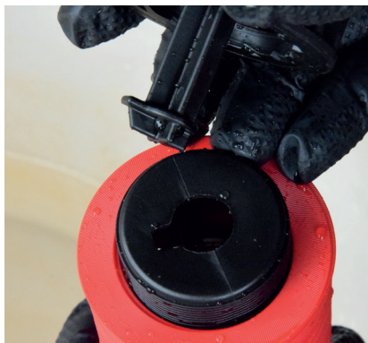
3) Togliere i dischi del filtro e lasciarli in ammollo per alcune ore con un acido, come aceto tal quale, per sciogliere il calcare depositato. Si sconsiglia l'impiego di acidi forti (ad esempio acido nitrico e acido cloridrico) perché fortemente caustici e pericolosi se non maneggiati con appositi dispositivi di protezione individuale. Procedere al risciacquo con acqua.
