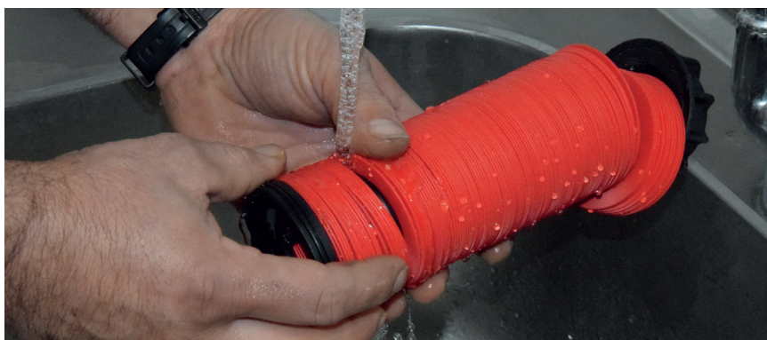
2) Pulire il filtro con acqua di rubinetto, per togliere il materiale più grossolano dalla superficie
